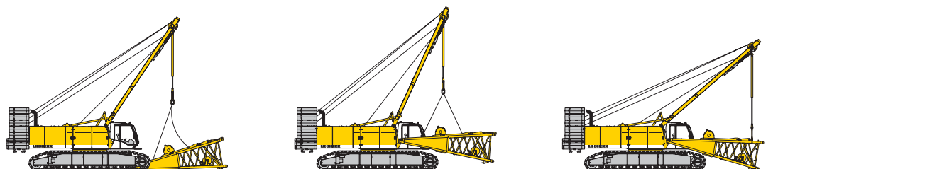
Entladung und Anbau des Auslegeranlenkstücks
