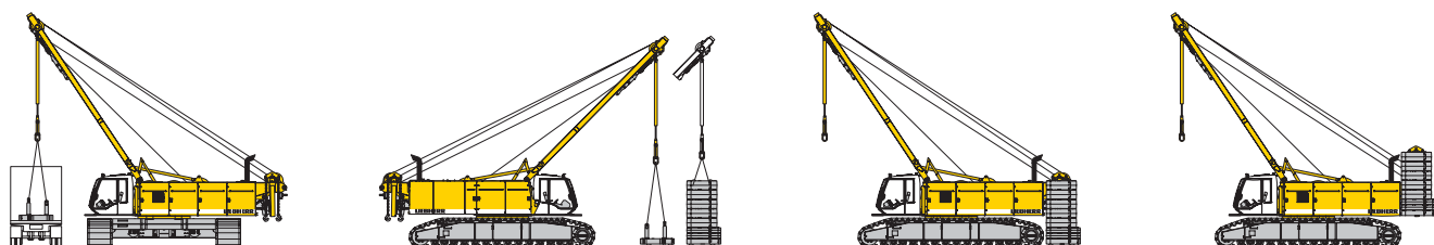
Entladung, Zusammen- und Anbau des Gegengewichtes
